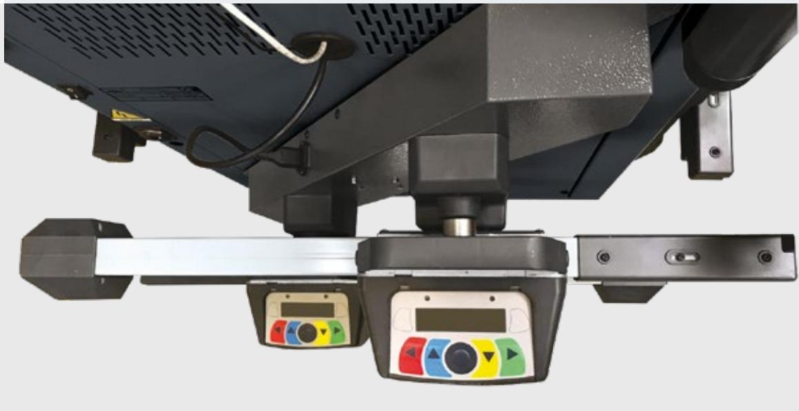
Permette di convertire l'assetto truck 6CCD, utilizzato prevalentemente per autocarri e autobus, con teste di misura ribassate ART86TWSR, in un assetto vettura compatibile con tutte le tipologie di veicolo. Si compone di un telaio facilmente fissabile posteriormente al cabinato grazie all'ausilio di due viti pre-esistenti negli angoli.
