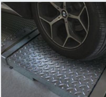
Attraverso l'ausilio di 16 celle (4 per ogni singola piastra) di cui si compone la piattaforma, i valori relativi a dati peso e forze frenanti sono acquisiti in un unico passaggio; permettendo di eseguire prove di frenatura anche a velocità estremamente ridotte.
