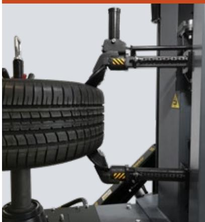
Sistema di stallonatura a doppio disco. Lo pneumatico viene stallonato in modo rapido e sicuro da due dischi opposti sincronizzati.
