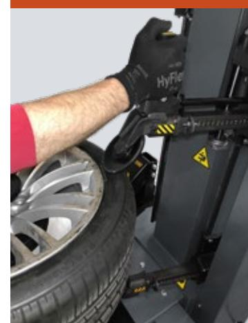
*Regolazione orizzontale dei bracci servoassistita. Servo-assisted horizontal arms adjustment.*
