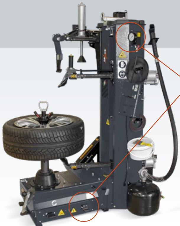
Gonfiaggio con azionamento a pedale, manometro e valvola di gonfiaggio rapido.
