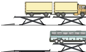
Per i modelli SF 7709-7713 è possibile l'installazione accoppiata con modalità di funzionamento "in singolo" o "in complessivo" con sincronizzazione elettronica.
