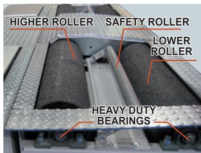
HIGHER ROLLER SAFETY ROLLER LOWER ROLLER HEAVY DUTY BEARINGS
